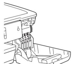
Tekan tutup tangki tinta ke bawah untuk menutupnya dengan rapat. Ulangi langkah ❸ untuk ketiga tangki tinta lainnya.
