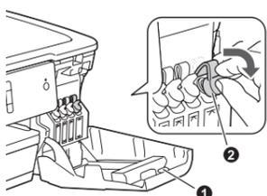
Buka penutup tangki tinta ❶ dan tarik tab ❷ ke bawah untuk membuka tutup tangki tinta.
