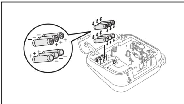
Masukkan enam baterai alkaline AAA (LR03) baru atau baterai Ni-MH (HR03) yang terisi penuh, pastikan kutubnya mengarah ke arah yang benar.
